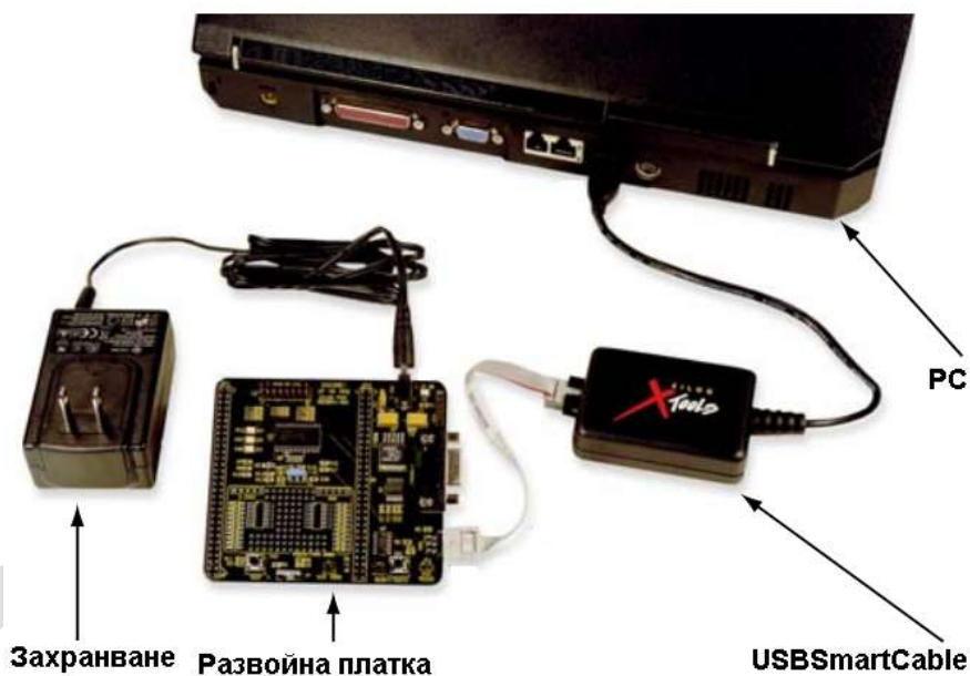
Фиг. 79 Свързване на дебъгера към платката и компютъра
