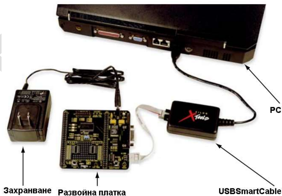
Фиг. 37 Свързване на дебъгера към платката и компютъра
