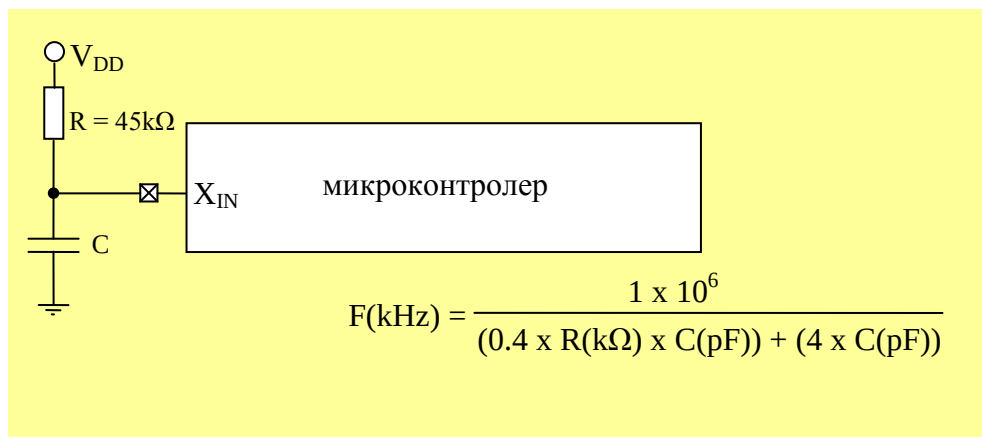
Фиг. 20 Външни компоненти на RC генератор
